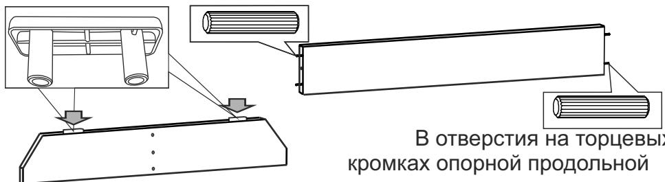
В отверстия на торцевых кромках опорной продольной стенки установить шканты.
